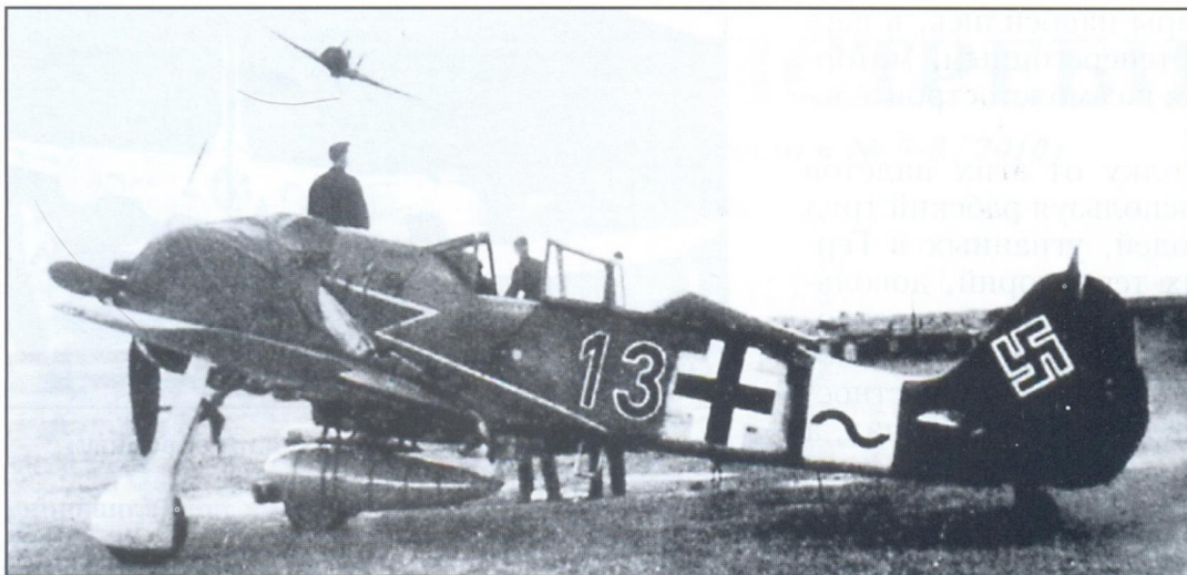
Перехватчик Fw 190A из состава специальной «штурмовой» части, оборудованный дополнительной броней. По бокам фонаря установлено бронестекло
