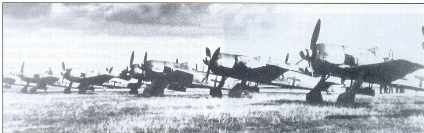
«Штурмовая» часть Fw 190. Обратите внимание на трубы под фюзеляжем перехватчиков. Тяжело бронированные Fw 190 в момент атаки бомбардировщиков не могли увернуться от истребителей сопровождения и, чтобы их отпугнуть, пускали ракеты, стреляющие назад. Трубы под фюзеляжем — пусковые установки ракет
